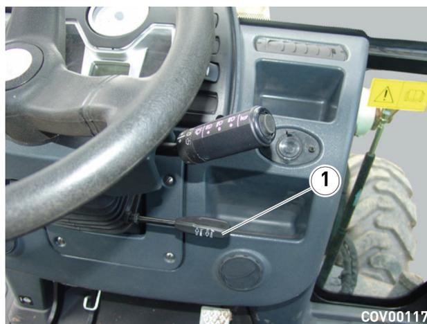
Рис. 4.9. - Фиксатор рулевой колонки
