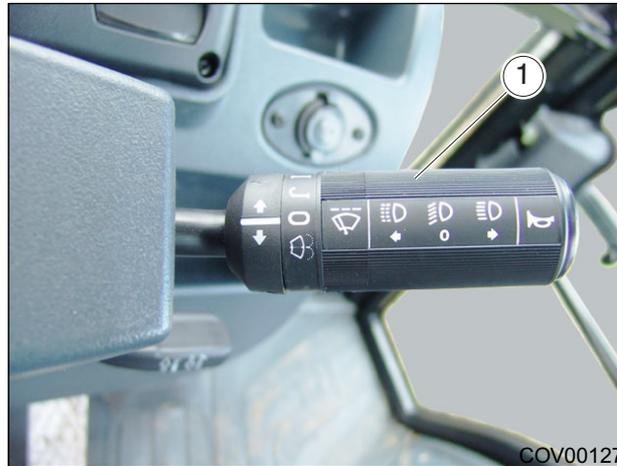
Рис. 4.20 - Многофункциональный блок управления
