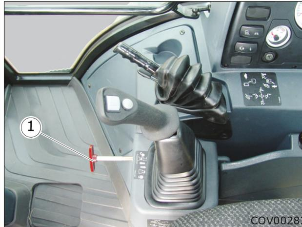
Рис. 4.30. - Блокирование органов управления погрузчиком
