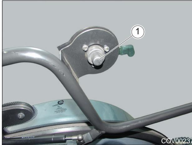
Рис. 4.74. - Фиксатор бокового окна
