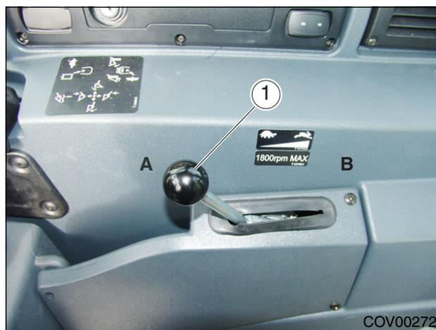
Рис. 4.18. - Ручка регулирования оборотов двигателя
