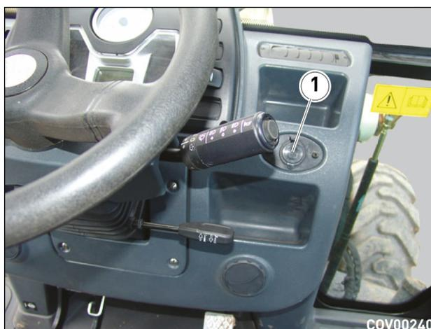
Рис. 4.78. - Гнездо 12 В, передняя панель управления
