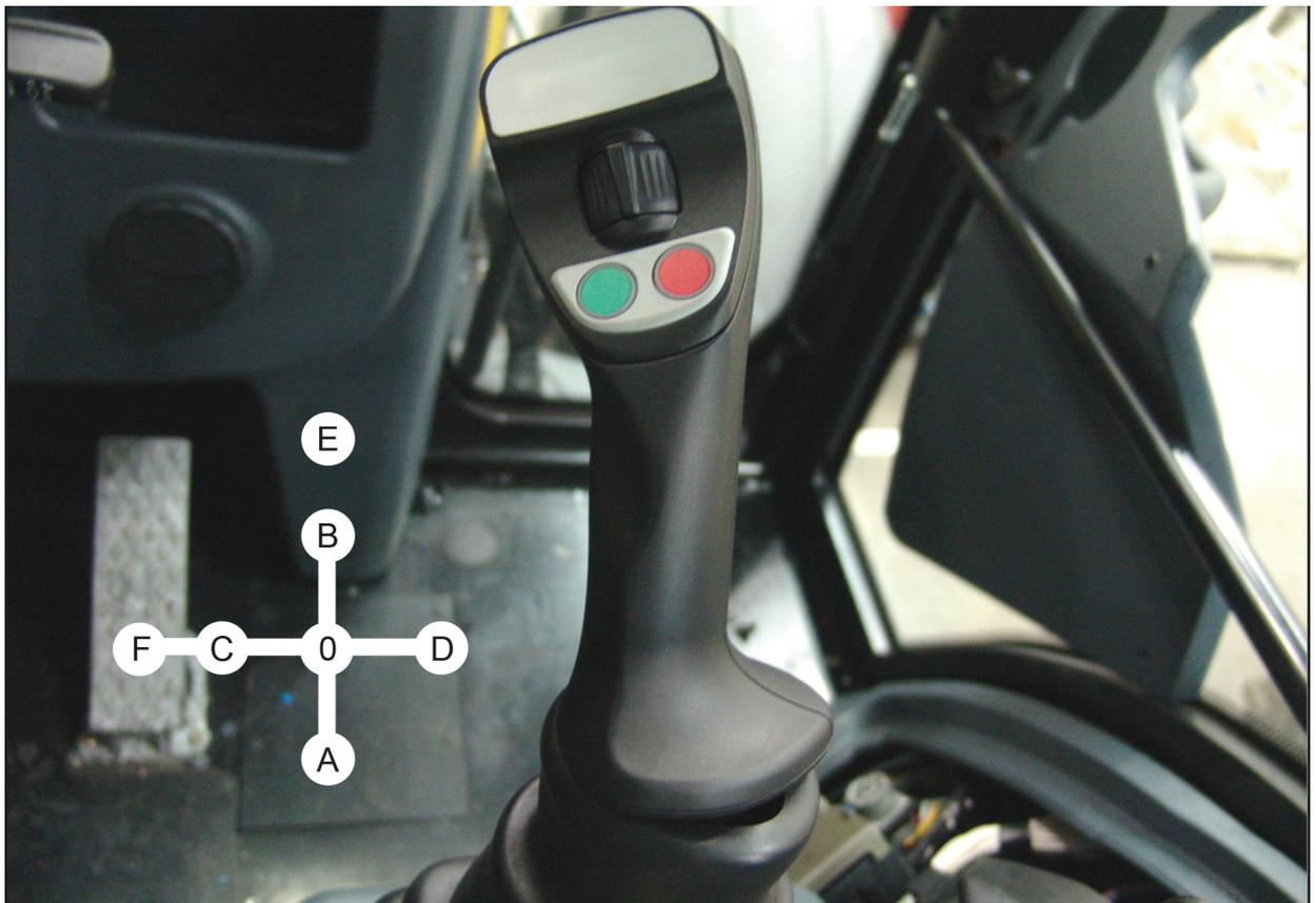
Рис. 7.12. - Функции джойстика погрузчика
