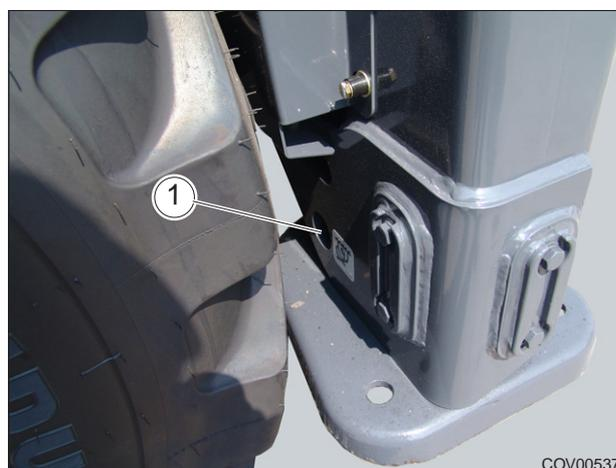
Рис. 5.3. Задняя точка строповки
