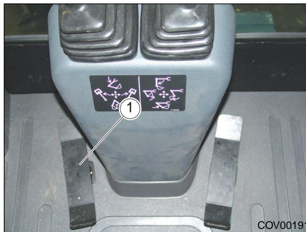
Рис. 4.65. - Педаль управления, вспомогательная гидравлика, механические органы управления
