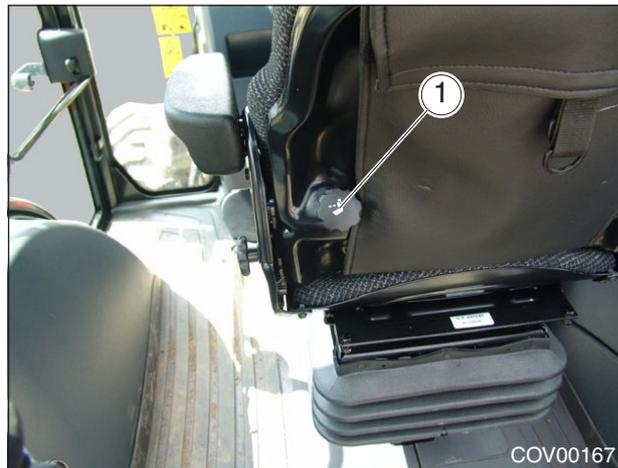
Рис. 7.7 - Регулировка поясничной опоры; механическая
