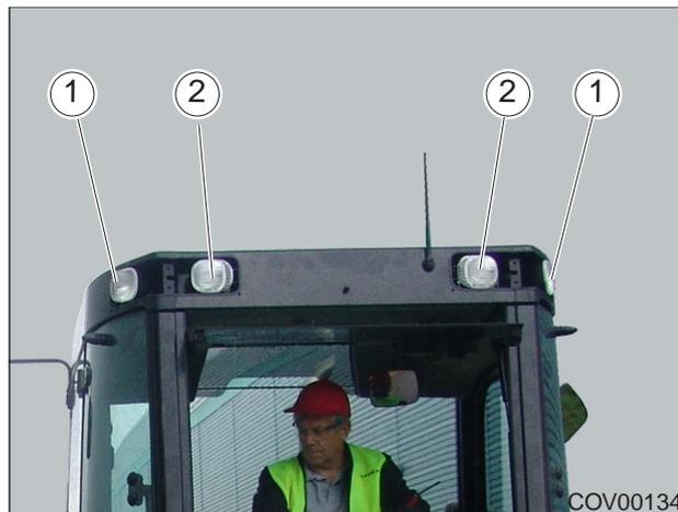
Рис. 4.26 - Заднее рабочее освещение
