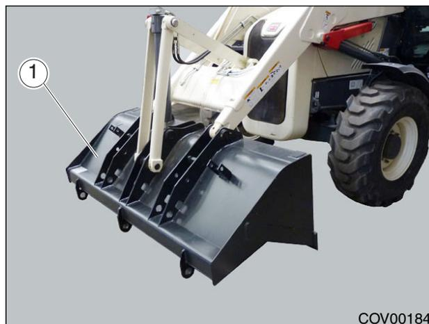
Рис. 7.24. - Стандартный ковш погрузчика - работа с обратной лопатой.
