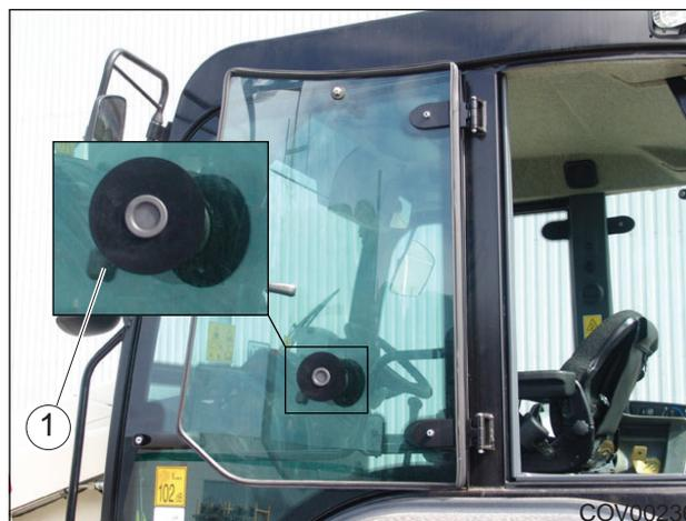
Рис. 4.73. - Механизм фиксации
