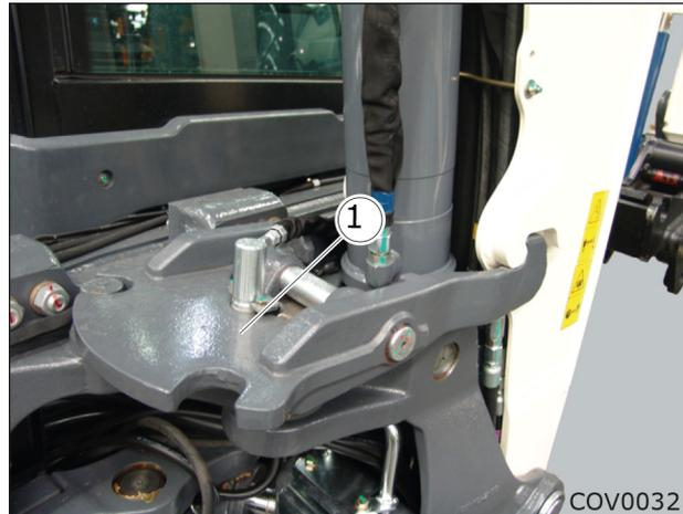
Рис. 4.63. - Транспортный фиксатор обратной лопаты
