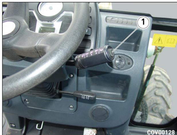
Рис. 4.21 - Кнопка звукового сигнала
