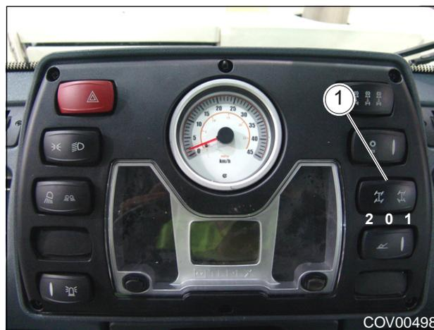
Рис. 4.10 - Переключатель режима рулевого управления
