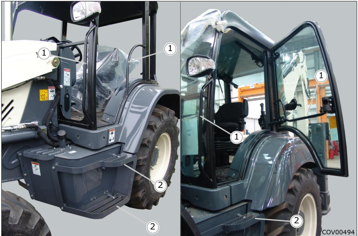
Рис. 4.67. - Приспособления доступа в машину
