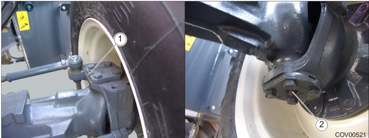
Рисунок 9.5 - Точки смазки, верхний и нижний поворотные шкворни переднего моста
