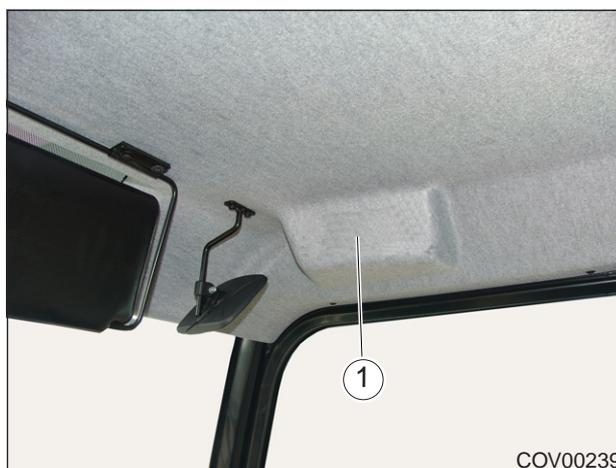
Рис. 4.77. - Отделение для радиоприемника
