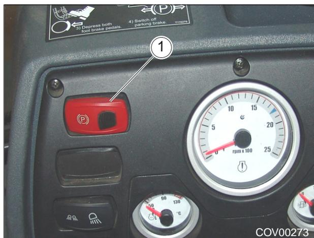
Рис. 4.13 - Выключатель стояночного тормоза SAHR
