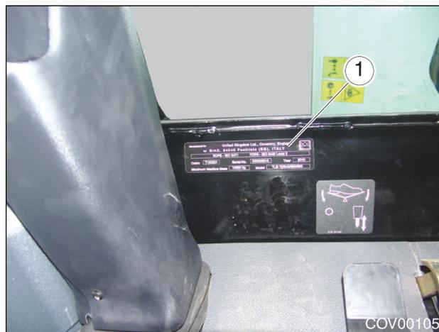
Рис. 1.9 - Расположение таблички с серийным номером ROPS/кабины.
