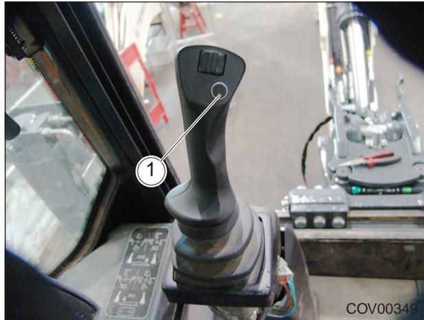
Рис. 4.66. - Кнопка звукового сигнала
