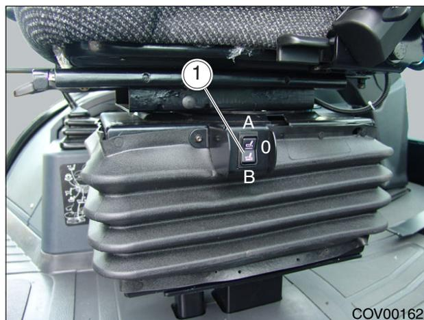
Рис. 7.2. - Регулировка по весу, пневматическая подвеска
