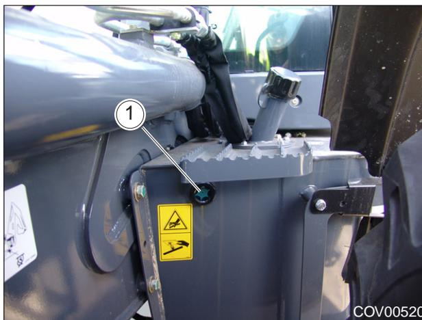
Рис. 6.3. - Визуальный указатель - гидравлический бак
