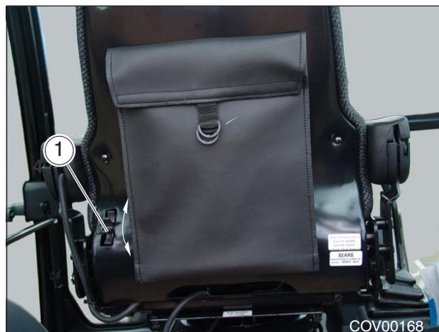
Рис. 7.8 - Регулировка поясничной опоры; пневматическая
