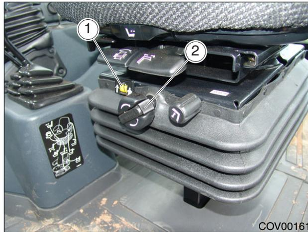
Рисунок 7.1 - Регулировка по весу; механическая
