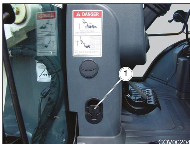
Рис. 9.2. - Рычаг открытия капота
