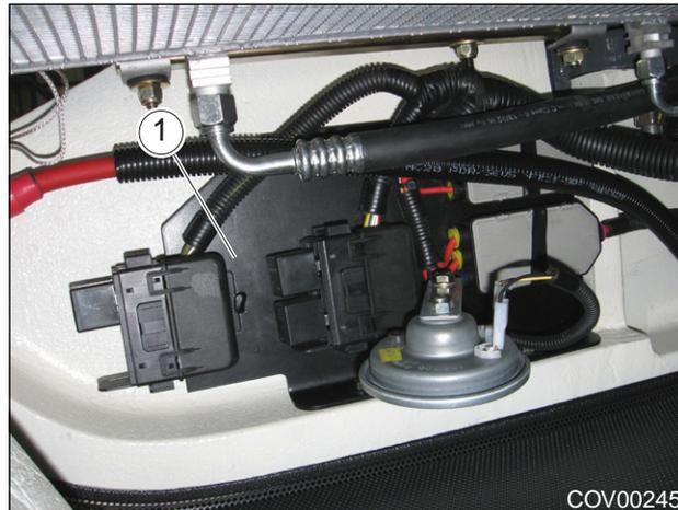
Рис. 9.9. - Расположение основной платы предохранителей и реле
