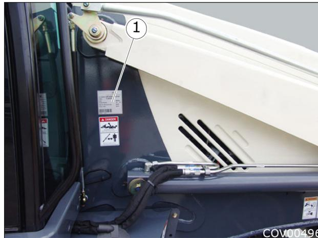
Рисунок 1.2 - Место расположения таблички с идентификационным номером машины
