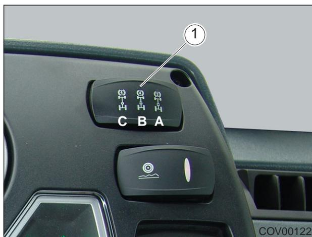
Рис. 4.14. - Переключатель привода на 4 колеса
