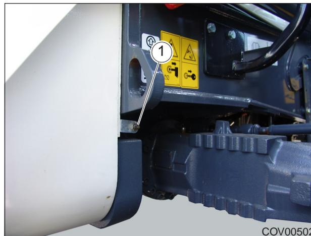
Рис. 9.4. - Точка смазки шкворня переднего моста
