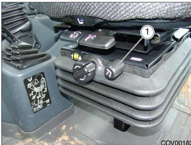
Рис. 7.3. - Регулировка по высоте
