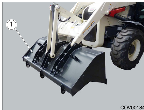
Рис. 7.10 - Ковш погрузчика — работа с обратной лопатой.
