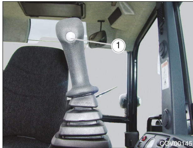
Рис. 4.32 - Кнопки принудительного переключения — джойстик.
