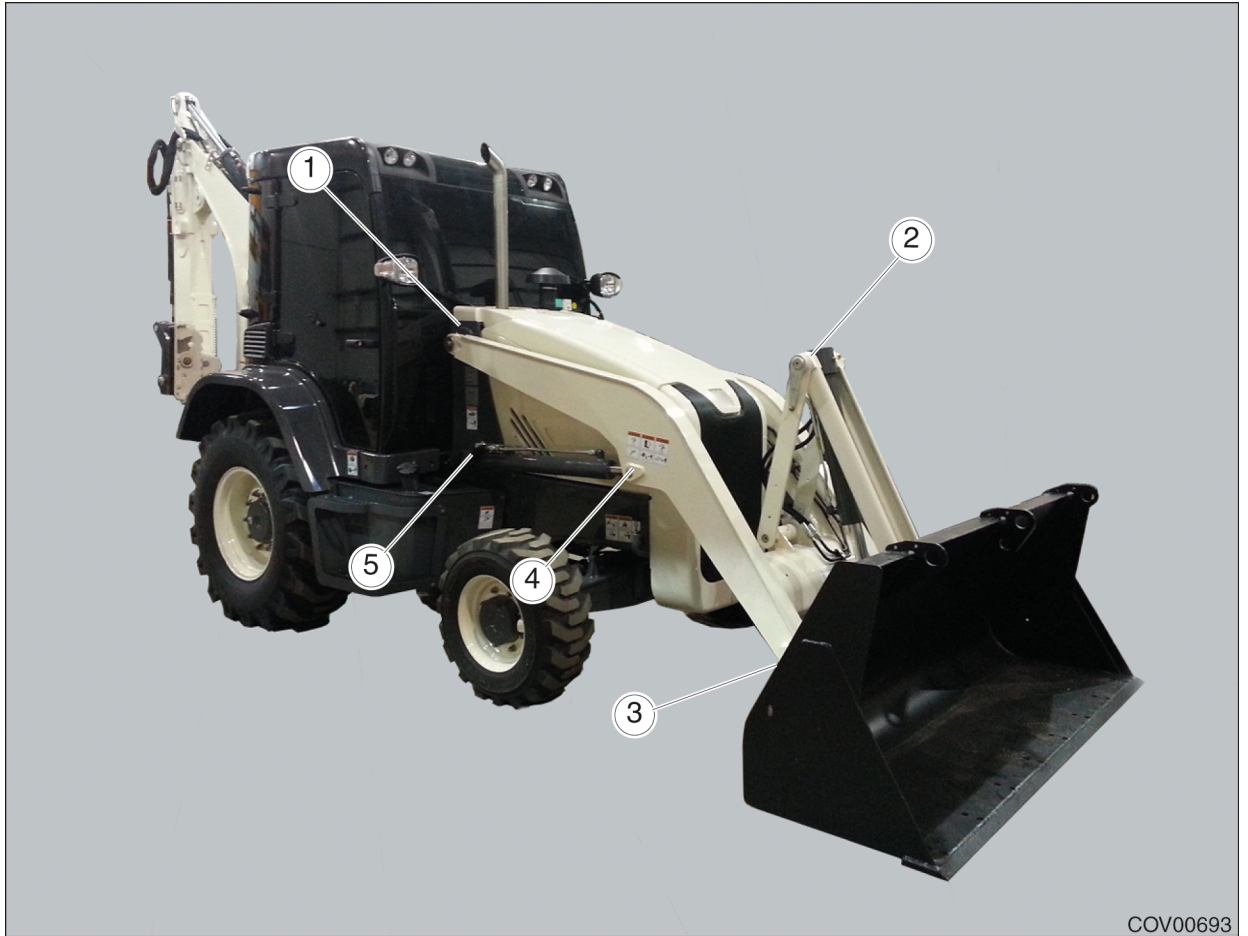
Рис. 9.6 - Точки смазывания, стрела погрузчика
